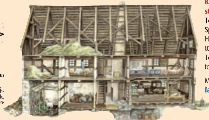
Schnittdarstellung eines Umgebindehauses in einer Aquarelldarstellung von Klaus Herzog
